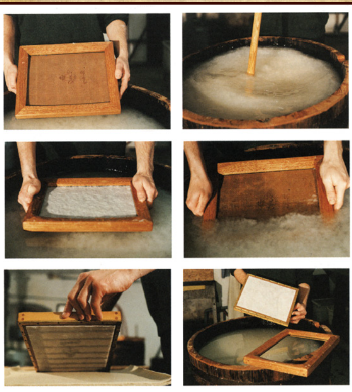
Praca przy czerpaniu papieru w młynie, formowanie arkuszy na sitach i przekładanie mokrego papieru.
