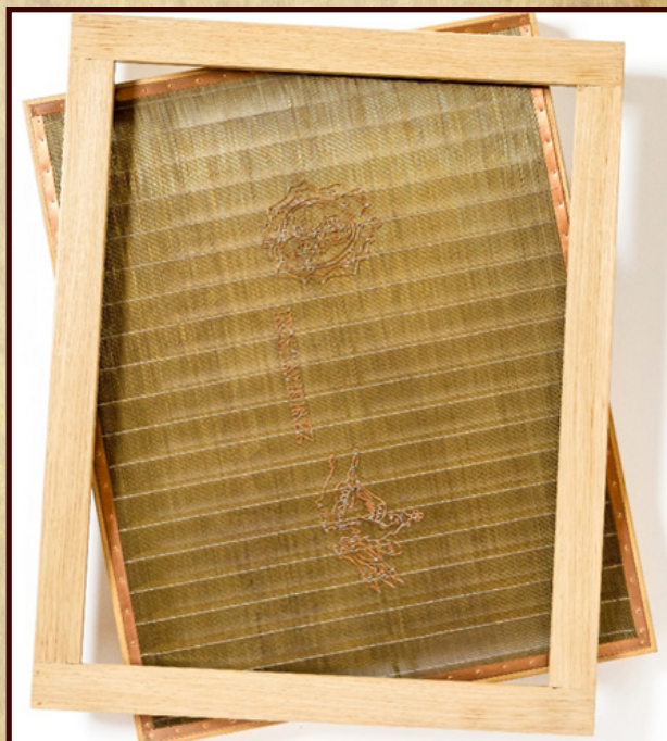
Przykład europejskiej formy do czerpania papieru składającej się z ramki (ogranicznika) i sita wykonanego z drutu.
