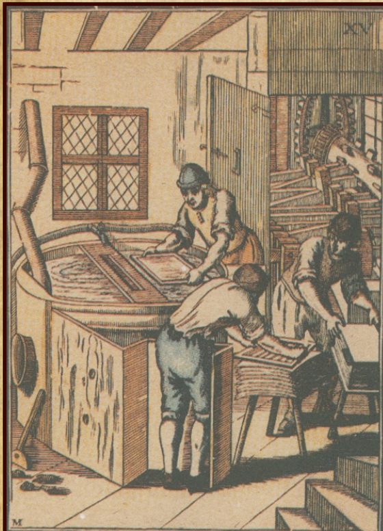
Praca przy czerpaniu papieru w młynie, formowanie arkuszy na sitach i przekładanie mokrego papieru.
