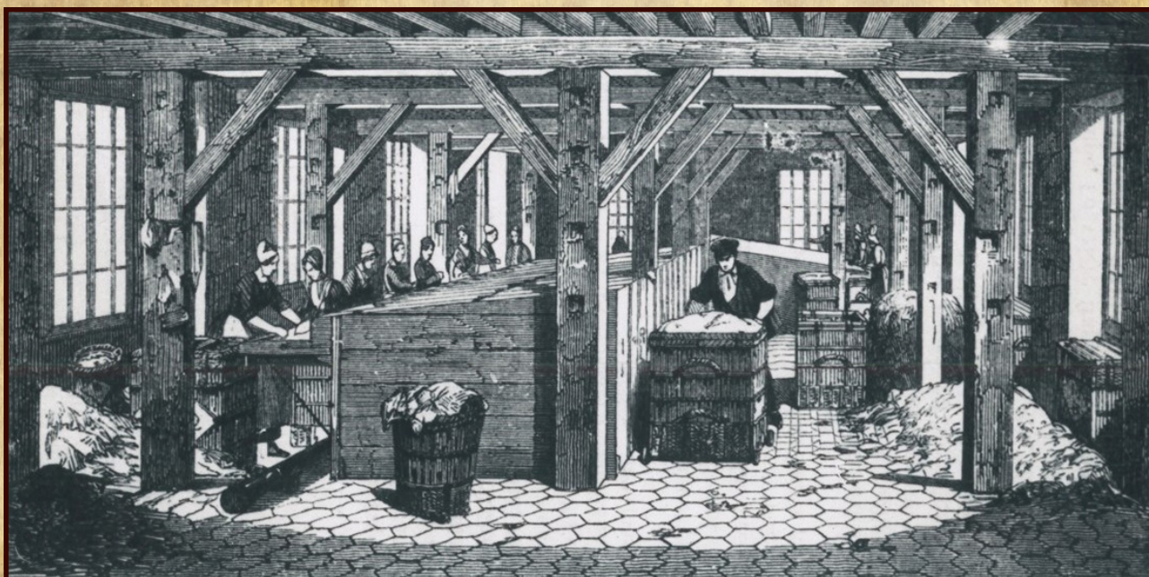
Pracownicy w młynie papierniczym – pomieszczenie szarpalni, w której następowało przygotowanie surowca – sortowanie i cięcie szmat.
